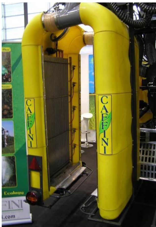
Slika 13.26: Tunelski stroj za tretiranje vinograda i niskih nasada voćnjaka (izvor: www.interempresas.net/Agriculture )
