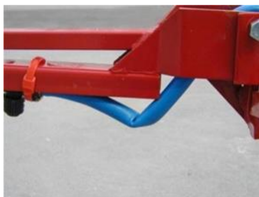
Slika 13.3: Najčešće pogreške na dovodnim crijevima (izvor: Unapređenje tehnike aplikacije pesticida, Đ. Banaj)
