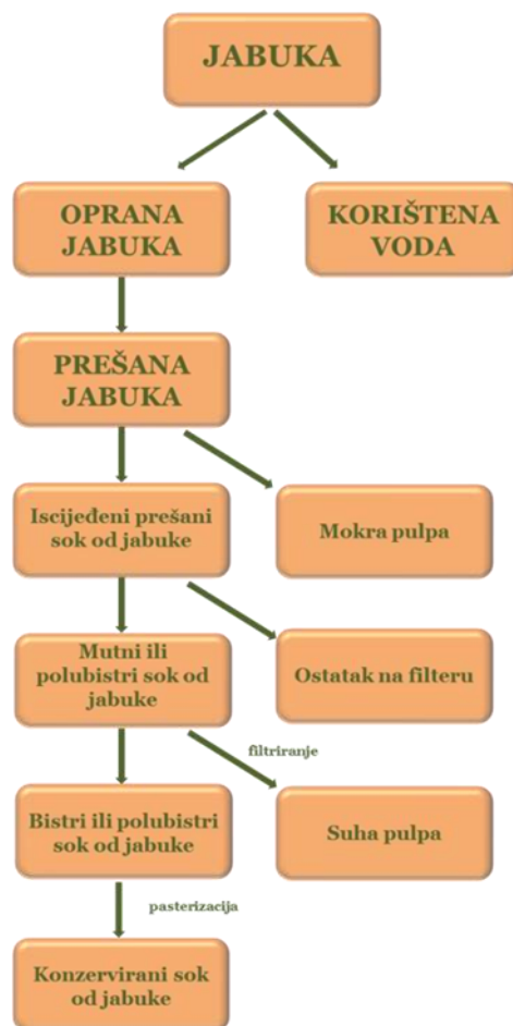
Slika 8.2: Shematski prikaz pripreme industrijskog soka od jabuke (nacrtala: D. Čelig)
