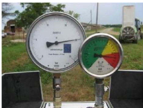
Slika 13.1: Kontrola ispravnosti manometra (izvor: www.amazone.com )
