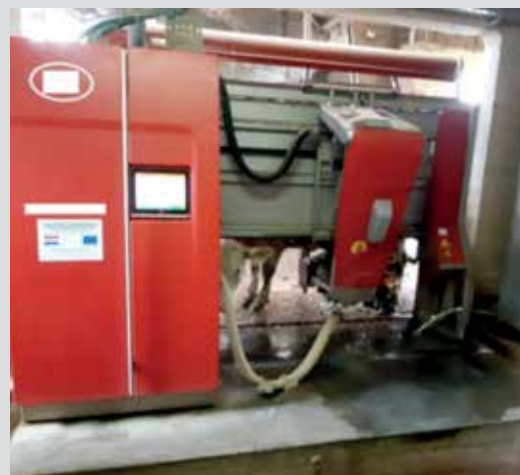
Slika 4. Robot za mužnju
