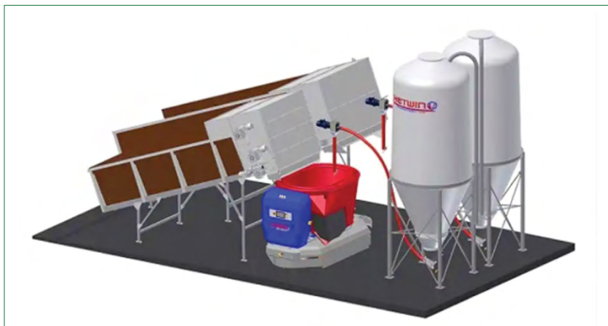
Slika 2. Shema priručne kuhinje kod robotizirane hranidbe
