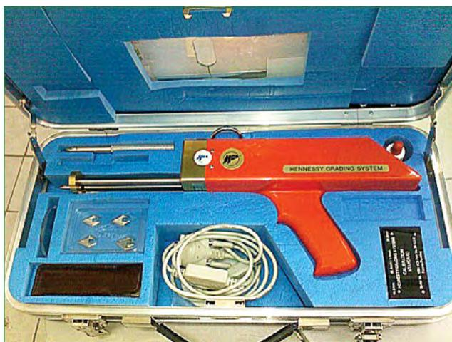
**Slika 5.** Uređaj Hennessy Grading probe – HGP7
