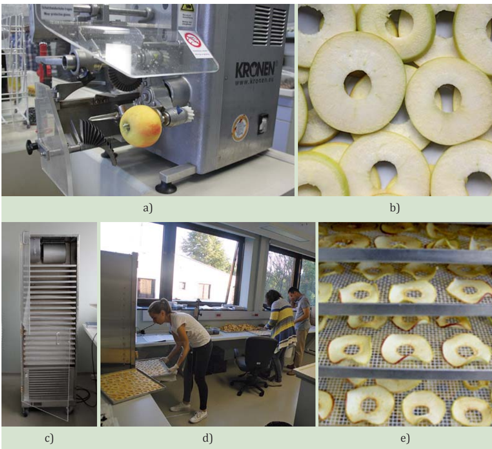
Slika 29. Priprema i sušenje plodova jabuke: a) strojno rezanje plodova, b) narezan plod jabuke na kolutiće bez sjemenjače, c) sušnica M. Bucher AG Typ 16B, d) punjenje sušnice narezanim plodovima jabuke, e) kolutići jabuka na polici za sušenje
